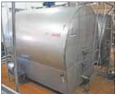
▲ Емкость для хранения сырого молока после процесса взвешивания и фильтрации.
