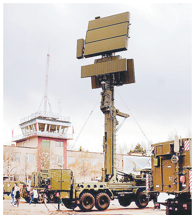
❹ Автоматизированная радиолокационная станция «Подлет»
